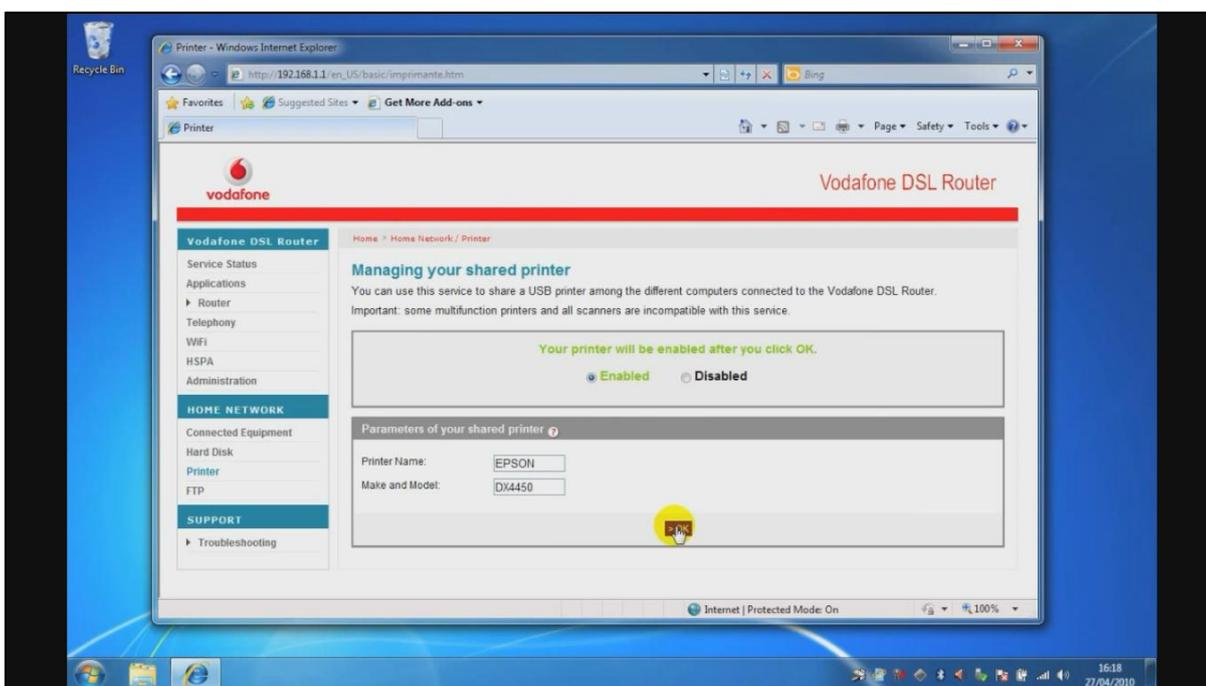
5. در این مرحله تنظیمات لازم بروی مودم انجام شده است و نوبت انجام تنظیمات لازم بروی کامپیوتر شماست تا بتوانید از پرینتر به اشتراک گذاشته شده استفاده کنید.
